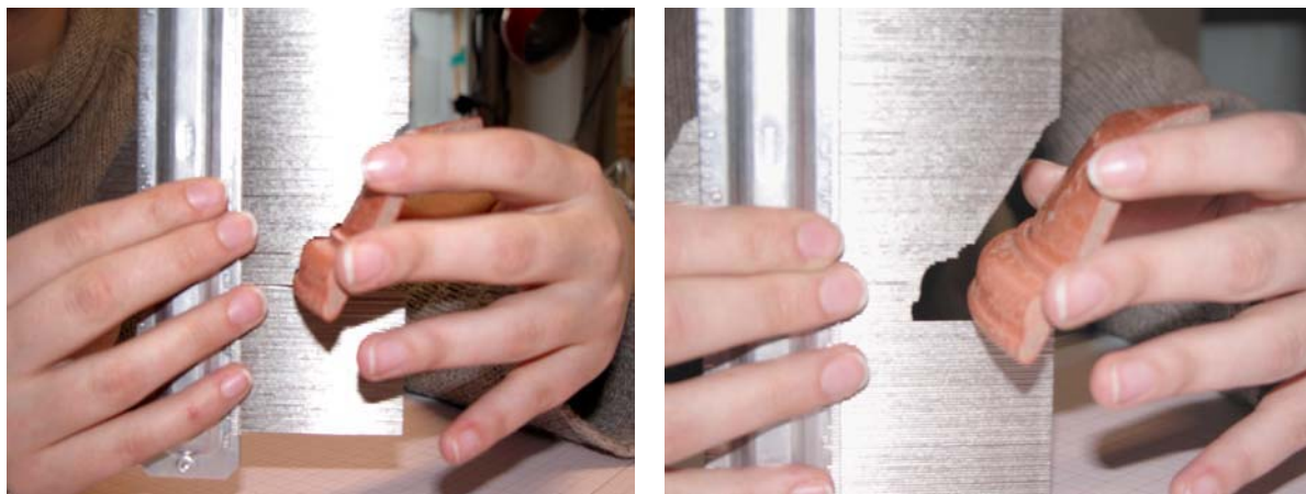
Fig.9 e 10: L'utilizzo del profilometro per rilevare il profilo;
