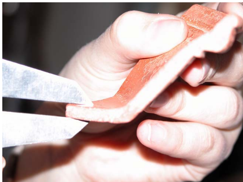
Fig.12: Misurazione dello spessore con l'ausilio di un calibro;
